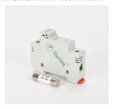
半封闭式熔断器的熔体装在瓷架上,插入两端带有金属插座的瓷盒中,适于低压户内使用。分断电流时,所产生的声光被瓷盒挡住。管式熔断器的熔体装在熔断体内。然后插在支座或直接连在电路上使用。熔断体是两端套有金属帽或带有触刀的完全密封的绝缘管。这种熔断器的绝缘管内若充以石英砂,则分断电流时具有限流作用,可很大程度上提高分断能力,故又称作高分断能力熔断器。若管内抽真空,则称作真空熔断器。若管内充以SF6气体,则称作SF6熔断器,其目的是改善灭弧性能。由于石英砂,真空和SF6气体均具有较好的绝缘性能,故这种熔断器不但适用于低压也适用于高压。浙江银河熔断器有限公司质量体系认证齐全,产品种类多样化,期待与您的合作。逆变器用熔断器保险管
